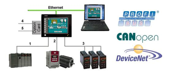
Avec 3 ports séries d'origine (jusqu'à 5 par une carte optionnelle) et un port Ethernet permettant de communiquer simultanément avec 4 protocoles différents, les G3 sont les plus puissantes plateformes de communication disponibles aujourd'hui. Choisissez le meilleur des automates, des contrôleurs de température, de vitesse et d'axes (etc...) et les terminaux G3 de Red Lion assureront la communication avec chacun d'entre eux.
