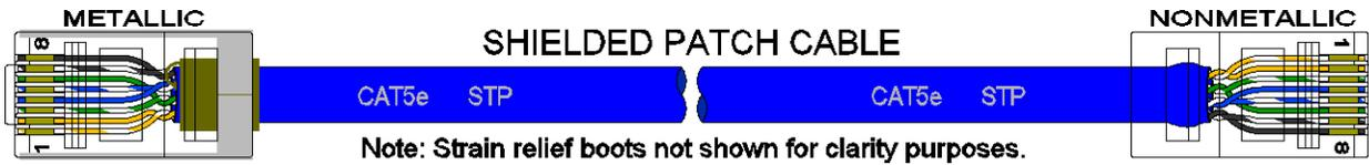
Für den Fall, dass alle Cat5e-Patchkabel-Abstände klein sind (d. h. alle Ethernet-Geräte befinden sich im gleichen lokalen Gehäuse und/oder beziehen sich auf dieselbe Masse), ist es zulässig, in Systemen ohne analoge Niederpegel-Signale; voll abgeschirmte Kabel zu verwenden, die an beiden Enden mit der Gehäusemasse abgeschlossen sind.
