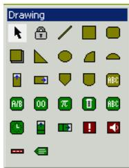
绘图工具箱是用来在页面上添加不同的元素，我们称之为元件。前两个图标是用来控制插入模式，其它的图标代表不同的元件。所有显示黄色的元件是基本的几何和动态图形；显示绿色的元件是多功能元件，它可以调用数据标签中的格式和其它信息来控制其操作；显示红色的元件是系统元件，如动态报警浏览器。所有工具箱中包含的元件都可以从 Insert 菜单中选取。
