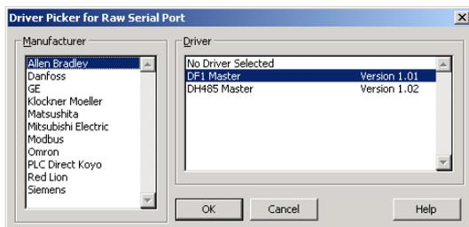
选择合适的制造商和协议，然后按 OK 键关闭对话框。此时通讯口已设置了相应的协议，一个设备图标出现在左手栏中。当你设置了一个通讯口，多个通讯口参数设置项（波特率，数据位，停止位和奇偶校验），将被设置为协议的缺省值。你可以仔细地检查这些设定，以确保符合设备的要求。
