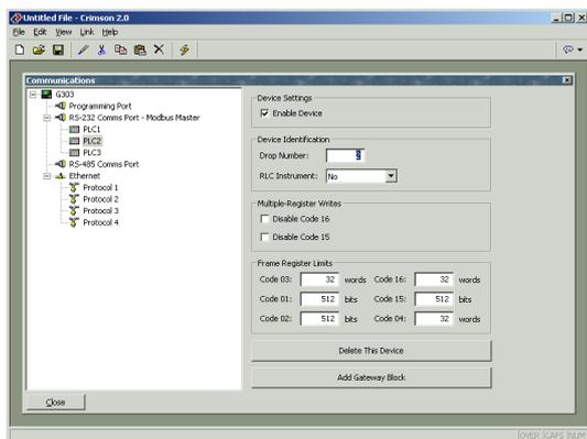
如上实例：选择了 Modbus Universal Master protocol，另增加了两个设备，总共有 3 个远端设备可以访问。右手栏中显示了单独设备的属性，Enable Device 属性适用于所有设备和协议，而其它项目是按所选协议的不同而不同。每个设备的名称是由 Crimson 按缺省名字命名的，点击相应图标，键入新的设备名就可更改了。
