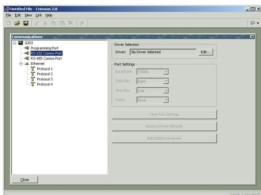
从上图可以看到，通讯窗口中以树状结构列出了设备的可用通讯口。G3 人机屏具有 3 个基本串行通讯口，在选项中可以用扩展卡增加 2 个通讯口。另外，还提供一个单独的，可同时运行 4 种协议的以太网口。
