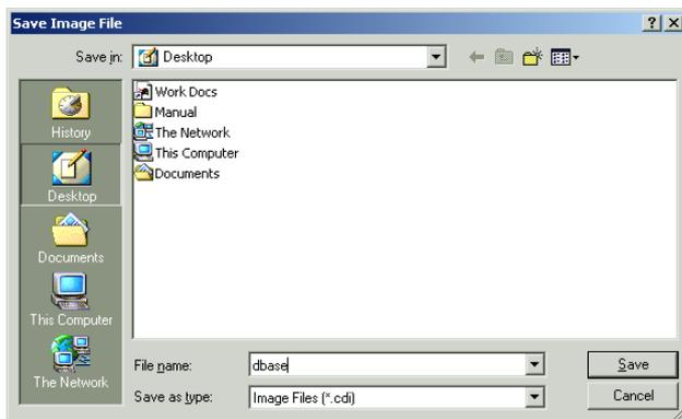
Save Image 指令将创建一个以 CDI 为扩展名的 Crimson 数据库文件的印象文件，它同时将当前 G3 的固件信息复制在一个以 BIN 为扩展名的文件中，印象文件必须是以 DBASE.CDI 为文件名，它和 BIN 文件都必须放置在 CF 卡的根目录下，当更新人机屏时，首先断电，插入 CF 卡（存有两个文件），重新上电，G3 的加载引导器首先检查是否需要更新设备固件，当此过程完成后，Crimson 的实时应用程序将加载存储于卡上的数据库文件，整个过程完成后，CF 卡就可以被卸除或按需要保留。
