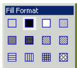
填充格式工具箱是用来控制显示元件的填充式样。如果选择一个或多个元件，然后点击选择一个填充式样，则所有选择的元件会显示同样的式样。如果当前没有选择元件，而点击一个式样，则以后新创建的元件都将显示此式样。不同的选项可以通过菜单中的 Format 来访问，或通过工具栏中的油漆桶图标访问。
