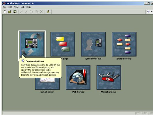
这个功能可以使用户浏览各个项目的相关帮助文件，如主页面中的各个图标，对话框和对话框的各个项目等。它是用工具栏最右边的图标来控制的，可以被设定为三种模式：不显示---气泡帮助功能不启用；鼠标指向时显示---当鼠标指向特定项目并停留时将显示相应帮助；选择时显示---当选择特定项目后显示相应帮助。
