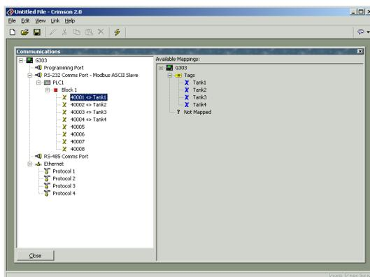
要指定数据块中的一个寄存器代表一个特定的数据项目，只需简单地拖动右手栏中的数据项目到左手栏中，并放置在数据块中的合适项上即可。上面的例子显示了怎样将数据块中的前 4 个寄存器映射到 Tank1 至 Tank4 的数据标签，这代表对寄存器 40001 到 40004 的访问会被映射至相应的变量。
