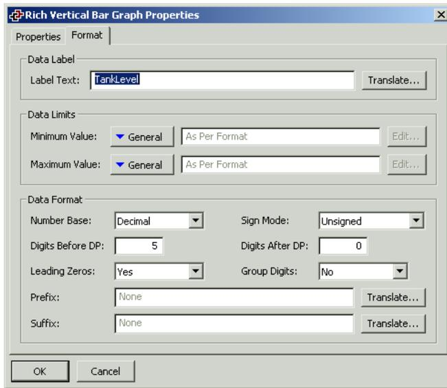
上面显示的各种属性的功能与整数型标签的解释相同，可参考上面相应的章节。需要特别提出的是，为什么此元件必须输入最大值和最小值？即使数据是公式型的，无法在界面上输入，也必须输入最大值和最小值，这是因为如果没有定义数据范围，Crimson 将无法标定液柱的大小。
