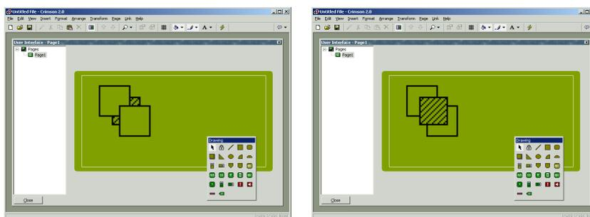
要在 Z 方向移动图形，首先选择图形，然后使用 Arrange 菜单中的不同命令来完成。Move Forward 和 Move Backward 命令是将图形向前和向后移动一层。Move To Front 和 Move To Back 命令是将图形移动到最上层和最底层。同时，如果你的鼠标是带有滚轮的，向前滚动滚轮是将图形移向底层，向下滚动则相反。
