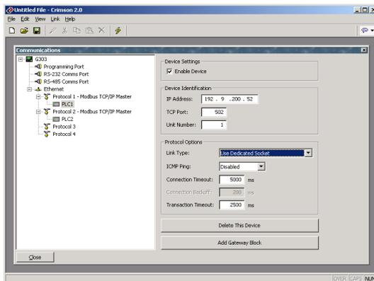
对于多数协议，这种方法具有较高的性能，因为它可同时与两个设备通讯。当然它也占据了 4 个协议中的 2 个，限制了你在复杂应用中增加新协议的空间。
