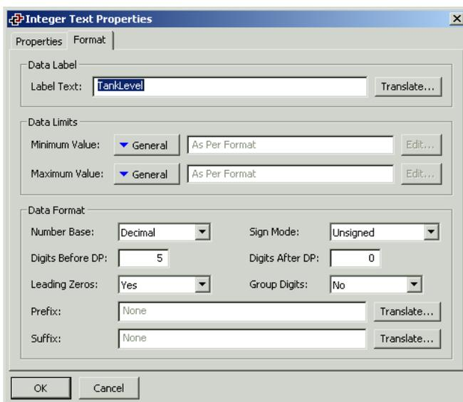
可以看到，所显示的属性与整数型标签的格式表完全相同。同样，其它类型元件的格式表也与相应类型标签的完全相同。详细信息可参考数据标签章节中解释。
