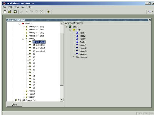
如果需要，你可以将数据块中的单独条目展开至组成位，并将不同的数据项目映射到每一个位。首先用右键点击所需的项，在弹出菜单中选择 **Expand** 指令，左手栏会被更新，将显示组成寄存器的每一个位，用同样的拖放方法完成数据映射。
