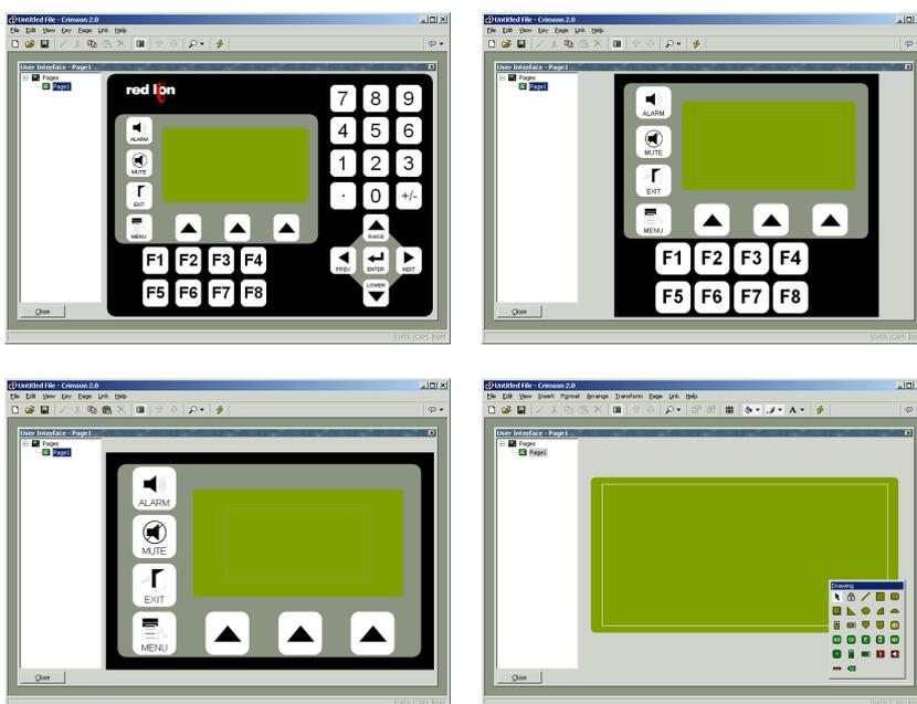
你可以看到,随缩放尺寸的增大,按键显示的越少,显示窗口越大。缩放尺寸的控制是在 View 菜单中,或使用工具栏中的放大镜图标,或 Alt 键加数字键 1~4。
