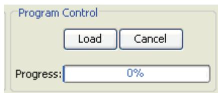
指示が出たら、スイッチの電源を切ってすぐに入れ直してください。ファームウェアを読み込むと、進行メーターは 100% に上昇し、読み込みが成功したことをメッセージで確認できます。
