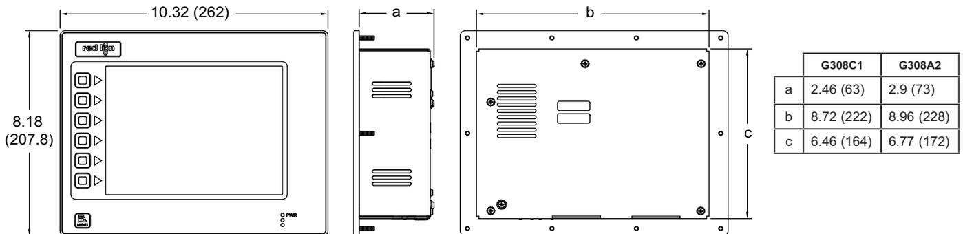
Erstellen Sie einen Ausschnitt und die Löcher für die Befestigungsschrauben gemäß der mitgelieferten Schablone. Achten Sie darauf, dass die Schnittkanten sauber entgratet sind, um das Bediengerät nicht zu beschädigen. Führen Sie das Bediengerät von vorne ein. Kontrollieren Sie dabei den korrekten Sitz der Gummidichtung.
