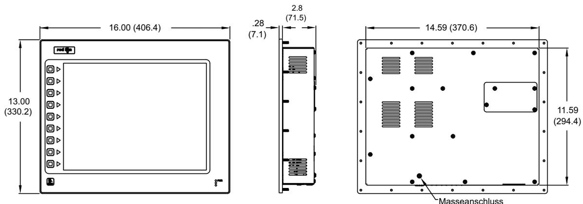
Erstellen Sie einen Ausschnitt und die Löcher für die Befestigungsschrauben gemäß der mitgelieferten Schablone. Achten Sie darauf, dass die Schnittkanten sauber entgratet sind, um das Bediengerät nicht zu beschädigen. Führen Sie das Bediengerät von vorne ein. Kontrollieren Sie dabei den korrekten Sitz der Gummidichtung.
