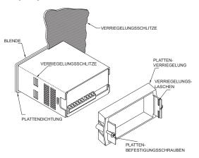
Plattenverriegelung in die Schlitze auf dem Gehäuse eindringen. Die Plattenverriegelung sollte in den möglichst am weitesten entfernten Schlitz eingefügt werden. Um eine korrekte Dichtung zu erzielen, ziehen Sie die Riegelschrauben fest, bis die Einheit in der Platte einrastet (Drehmoment bis ungefähr 7 in-lbs [79 N-cm]). Ziehen Sie die Schrauben nicht allzu fest.
